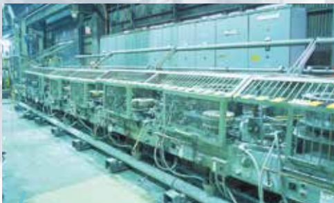
冷加工 连续拉线机
