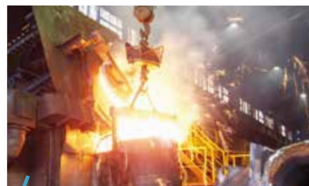
溶解 高周波誘導炉
